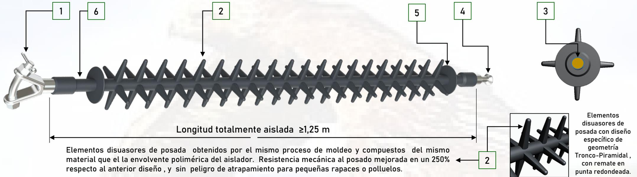
Elementos disuasores de posada obtenidos por el mismo proceso de moldeo y compuestos del mismo material que el la envolvente polimérica del aislador. Resistencia mecánica al posado mejorada en un 250% respecto al anterior diseño , y sin peligro de atrapamiento para pequeñas rapaces o polluelos.
